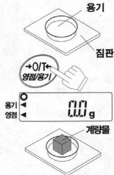
**영점/용기** 키를 누르면 계량값이 전원 ON Zero 포인트에 대해서 최대중량값의 ±2%이내의 경우에는 저울이 Zero점을 설정합니다. 이때 Zero점 마크 ◀가 점등합니다. 계량값이 중량값의 ±2%를 넘는 경우에는 용기무게제거를 실행하고, Zero점의 마크는 용기무게제거중의 마크가 점등합니다.
